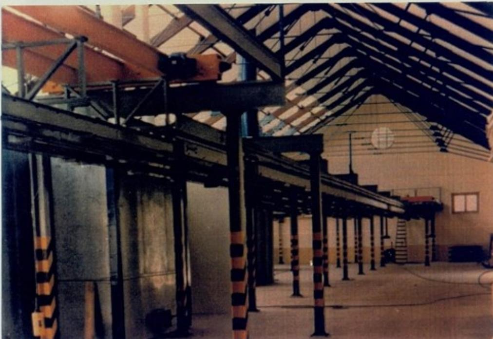
Taller de Pintura, con transfer de transporte, cabinas de limpieza y de pintura y hornos de secado.
