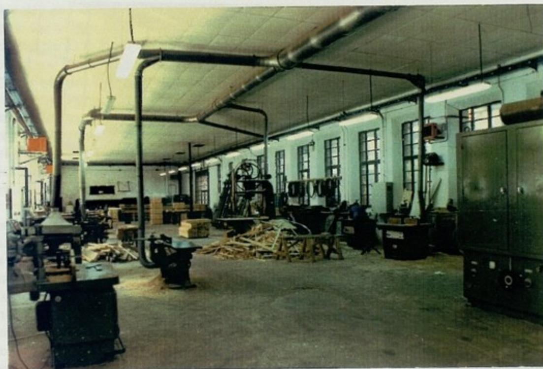
Taller de Carpintería. Obsérvese el sistema de extracción de viruta localizado en cada máquina. Entre los equipos fundamentales del taller constan una moldurera universal, prensas de calor para tableros, lijadoras de 4 bandas y prensas hidráulicas para paneles.
