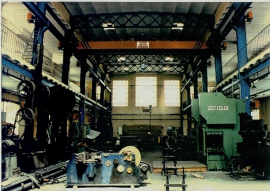
Remodelación del Taller de Forja. Nuevos accesos y maquinaria. Arriba la grúa puente de dos potencias; al fondo la plegadora de 6 metros y 240 Tm.; a la derecha prensa de doble montante de 160 Tm. Alternadas se observan máquina antiguas de buen rendimiento.
