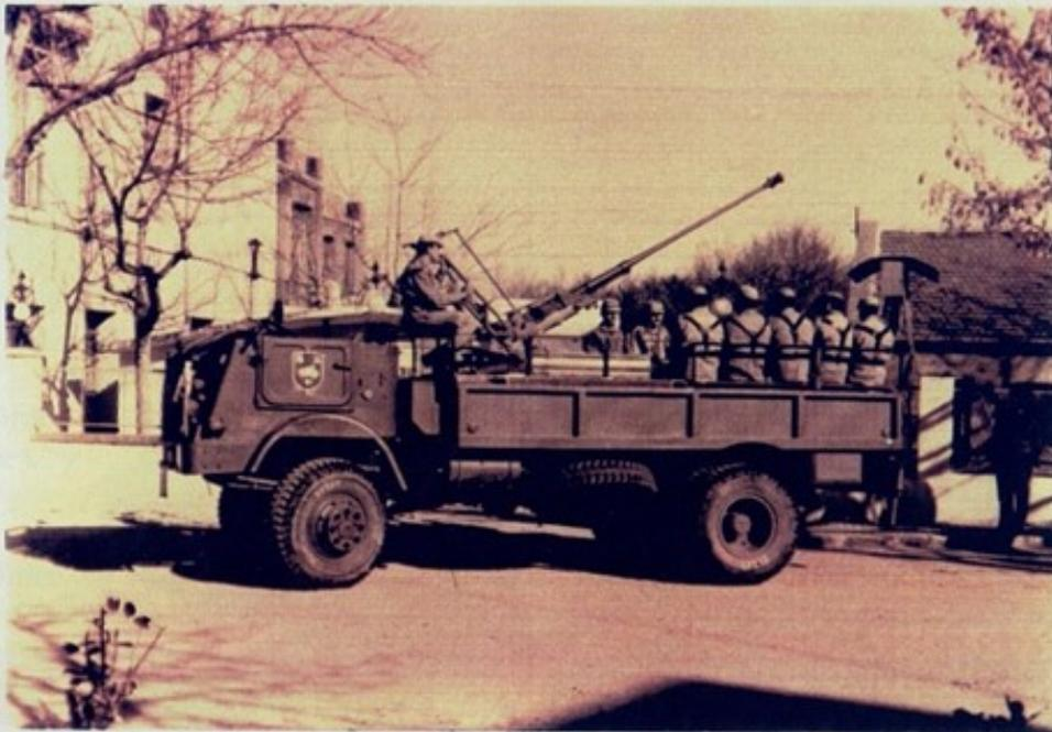
Montaje sobre camión del Cañón Antiaéreo Oerlikon de 20 mm.
