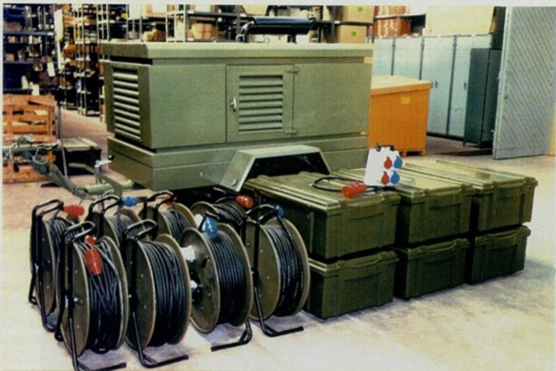
Composición del Equipo de alumbrado tipo B/95
