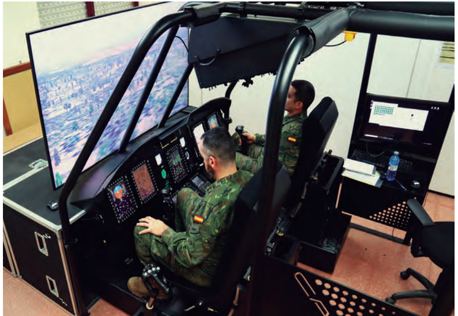
A la espera del simulador de Indra, las tripulaciones cuentan con sistemas virtuales como el entrenador de procedimientos de base fija CAPT-E.
