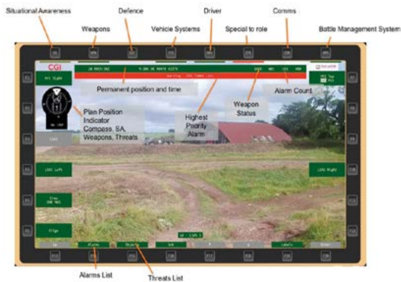
Detalle de la configuración de pantalla y botones según la GVA (fuente: DDS foundation)
