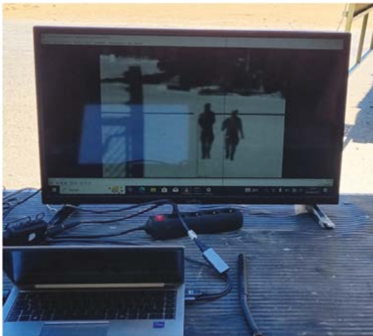
Imágenes en tiempo real emitidas por unun SPIKE a través de una SPEARNET
